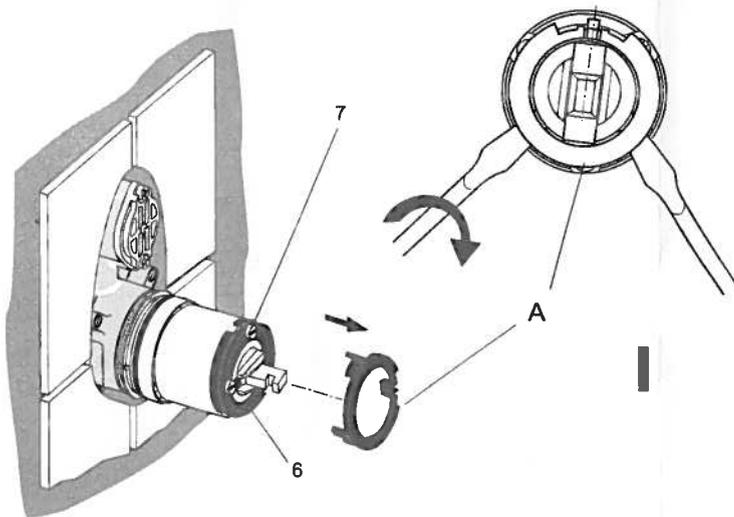
• Zulaufleitungen absperrn. Stelling (Temperaturbegrenzer) A durch wechselseitiges Abhebeln mit einem Schraubendreher entfernen. Schrauben 7 lösen und Kartusche + Rasterring 6 herausnehmen.
